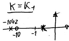
Sistema Criticamente amortiguado
