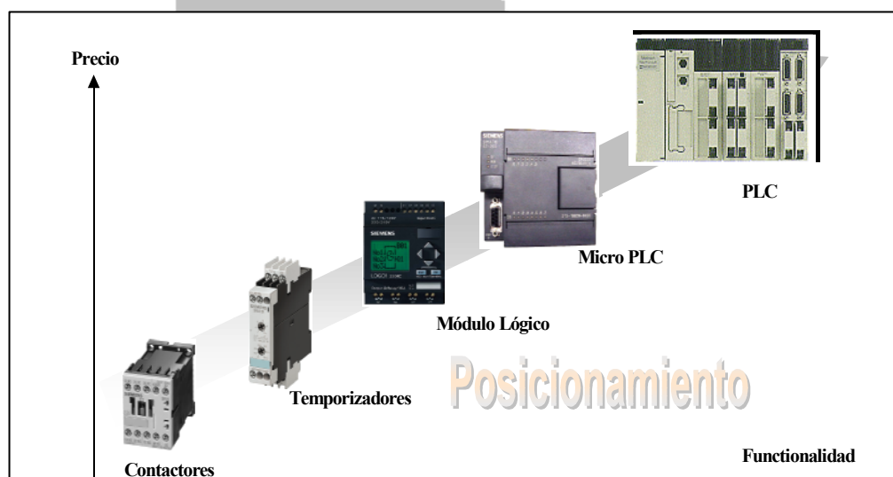
Ilustración 9 Controladores eléctricos y programables
