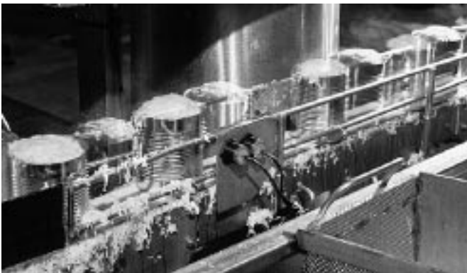
Detectores XS de Telemecanique en la industria agroalimentaria
