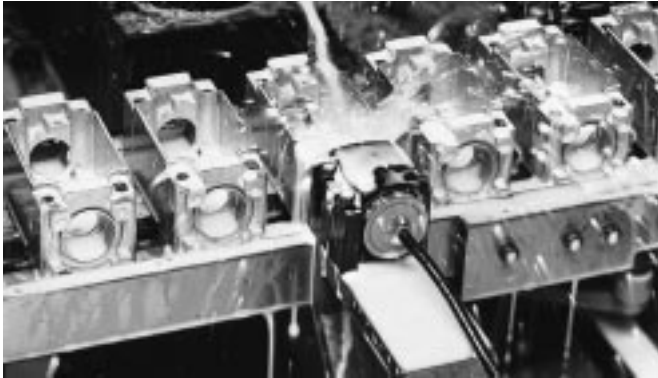
Detector XS de Telemecanique sobre transfer de mecanizado
