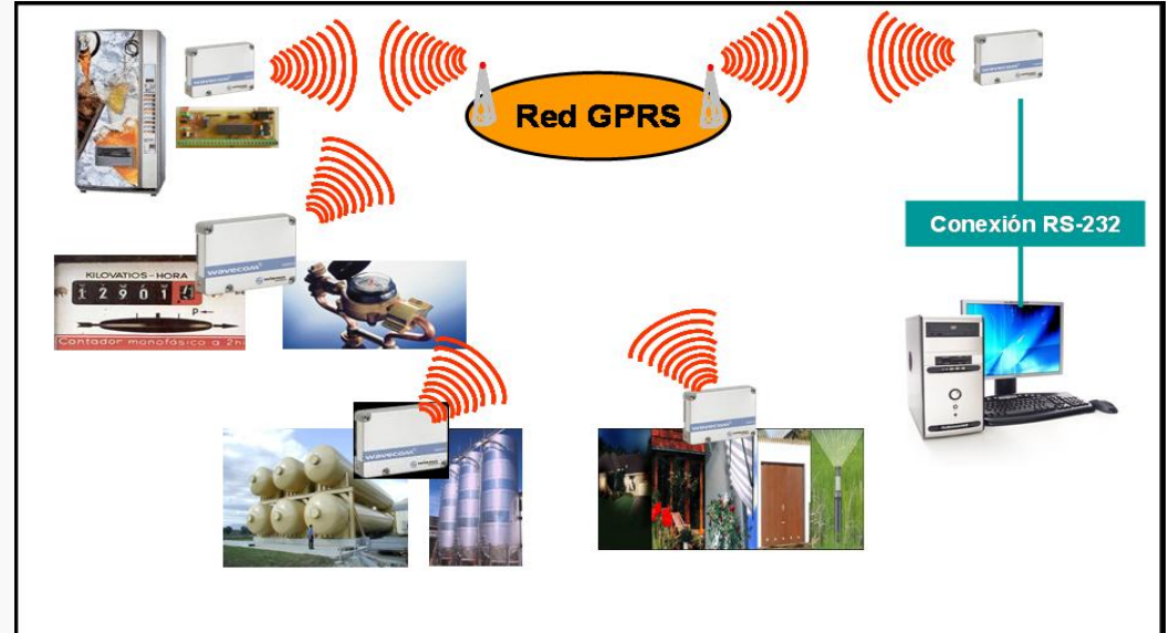
Sistema Electrónico de Captación de señales Analógicas o Digitales para envío por módem GSM/GPRS
