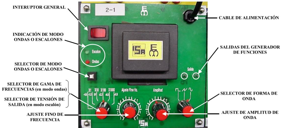
El generador de funciones que incorpora puede trabajar en dos modos de funcionamiento, seleccionables mediante el SELECTOR DE MODO e identificables mediante los LEDs verde (modo escalones) y rojo (modo ondas):
