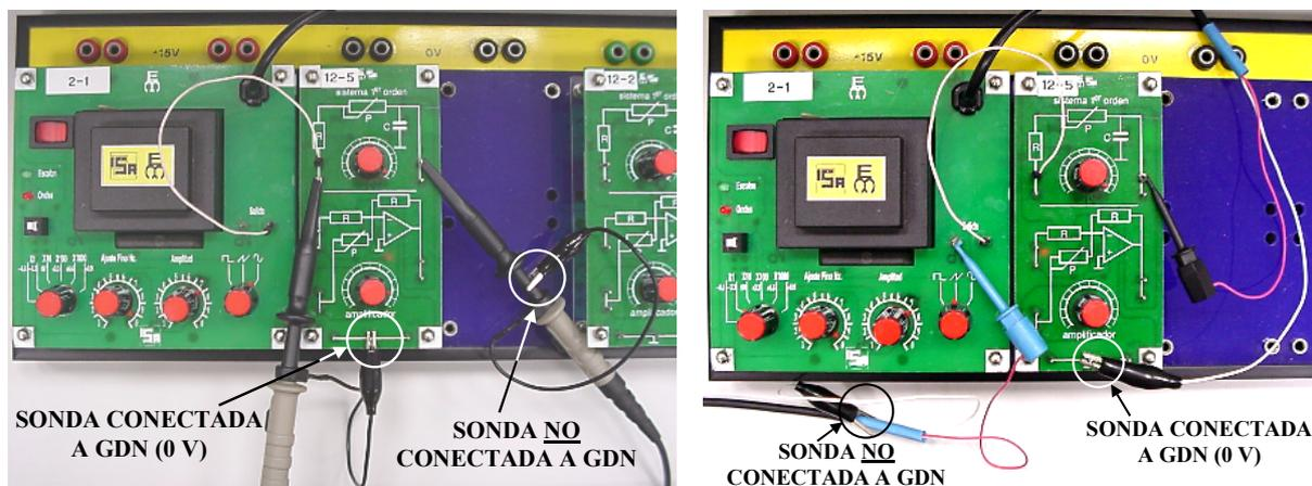
**IMPORTANTE:** Las PINZAS B de dos sondas conectadas a dos canales de un mismo osciloscopio están unidas internamente a través del osciloscopio. **NO LAS CONECTE NUNCA A PUNTOS CON TENSIONES DIFERENTES, YA QUE PROVOCARÁ UN CORTOCIRCUITO.**
