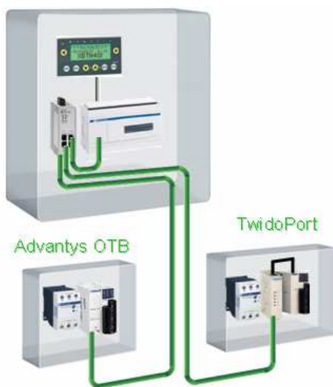
Ejemplo de arquitectura Ethernet
