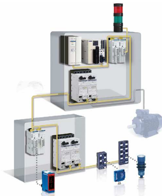
Esquema ejemplo de comunicación ASI
