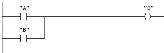
Figura 2: Implementación en KOP de la función OR
