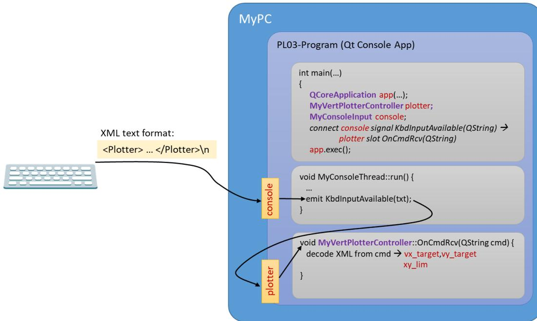
Esquema de control del plotter vertical:
