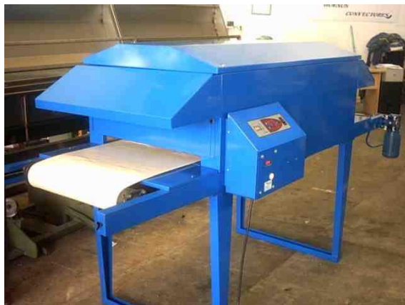
Control de temperatura en horno-túnel
