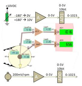
ad1=Leer canal AD1  $\rightarrow$  calc  $u_{ad1}(V) \rightarrow$  calc  $u_{sens1}(V) \rightarrow$  calc  $pos_{mot}$  (deg)
