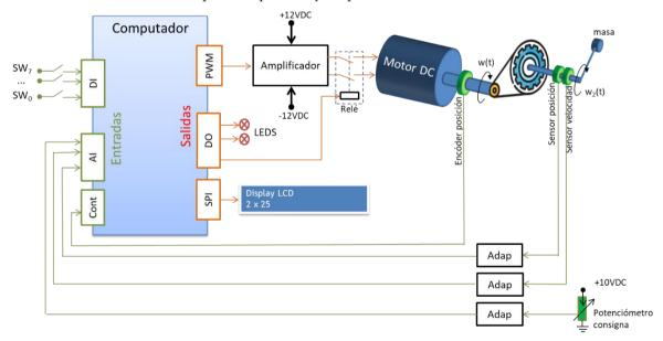
Se desea realizar sobre este sistema un control básico de velocidad en cadena abierta, con las siguientes especificaciones:
