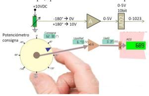
Función: float GetPotRef\_deg(); ad2=Leer canal AD 2  $\rightarrow$  calc  $u_{ad2}(V) \rightarrow$  calc  $u_{sens2}(V) \rightarrow$  calc pos\_ref (deg)
