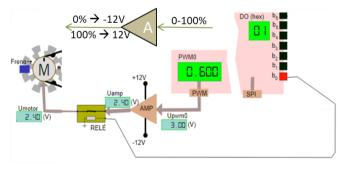
Función: void SetUmotor\_V (float u<sub>m</sub>);  $U_{mot}(V) \rightarrow calc duty (tanto por 1) \rightarrow calc Ton (Tpwm=cte=1000) \rightarrow Aplicar PWM$
