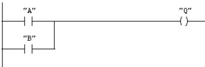
Figura 3: Implantación en KOP de la función OR
