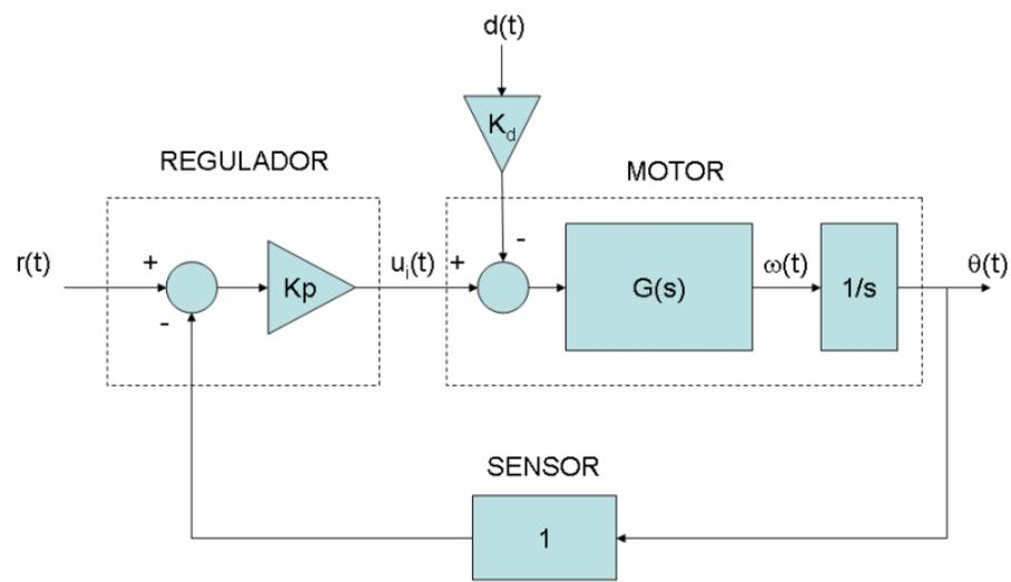
Figura 2: Diagrama de bloques del control de posición.
