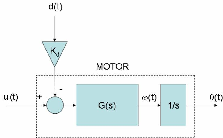
Figura 1: Diagrama de bloques del motor.
