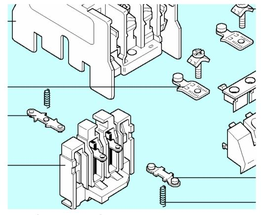
Consta de una parte fija y una parte móvil. Esta última incluye unos resortes que transmiten la presión correcta a los contactos que están fabricados con una aleación de plata con una excepcional resistencia a la oxidación, mecánica y al arco.
